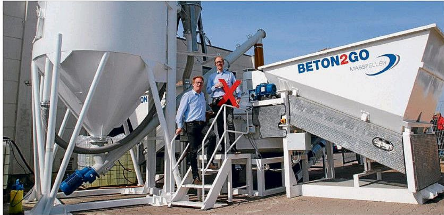
Nahmen die Maschine in Betrieb: Die beiden Brüder und Geschäftsführer Peter (links) und Heiner gr. Beilage. In dem rund neun Meter hohen Silo (links) befinden sich 30 Kubikmeter Trasszement. Foto: Smalian
