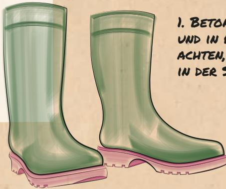
1. BETON DÜNNFLÜSSIG ANRÜHREN UND IN PVC-STIEFEL FÜLLEN. DARAUFGAHTEN, DASS SICH KEINE LUFTBLASE IN DER SCHUHSPITZE BILDET.
