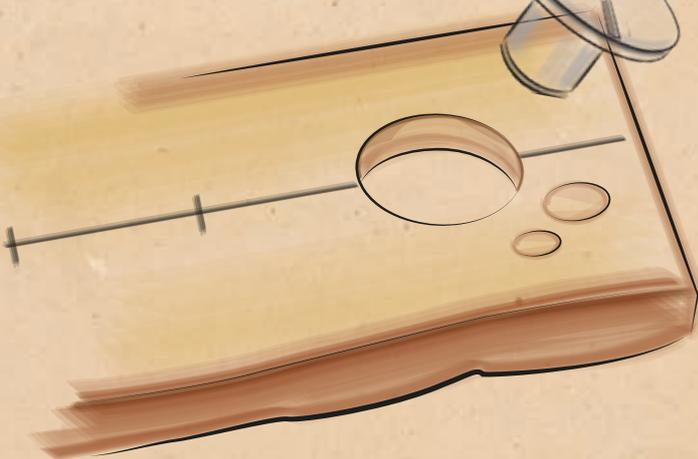
2. AN JEDER ECKE LOCH BOHREN UND SEIL VON OBEN EINFÄDELN. MIT FESTEM KNOTEN FIXIEREN.
